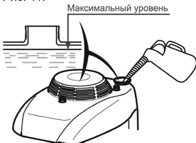
Рис. 11 Максимальный уровень топлива в топливном баке
