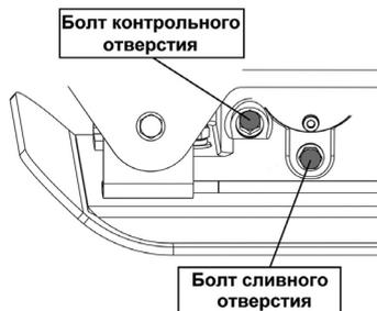
Рис. 20 Отверстия для заправки и слива масла
