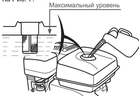
Рис. 7 Максимальный уровень топлива в топливном баке
