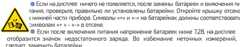
● Если после включения питания напряжение батареек ниже 7,2В, на дисплее отобразится значок недостаточного заряда. Во избежание неточных измерений, следует, заменить батарейки.
