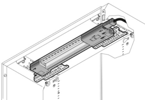
Установка светильника на светодиодах
