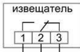
Рисунок 2б. Схема подключения ИО102-51(П)
