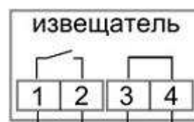
Рисунок 2в. Схема подключения ИО102-51(НР+Пр)
