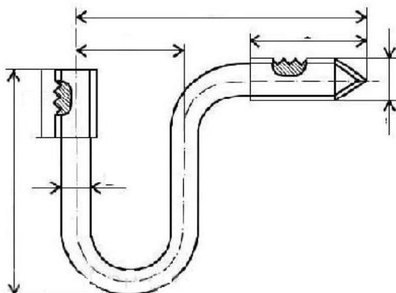
Крюки КН-22 (КВ-22; К-22) служат для крепления изоляторов ШФ-10, ШФ-20, ШС-10 к деревянным опорам. Для фиксации изолятора на крюке следует применять колпачок КП-22.
