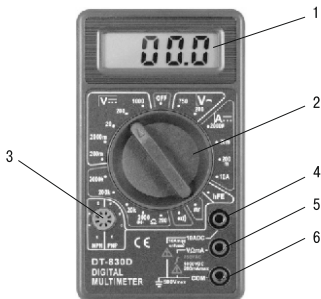
Рисунок 1 – Элементы лицевой панели мультиметров
