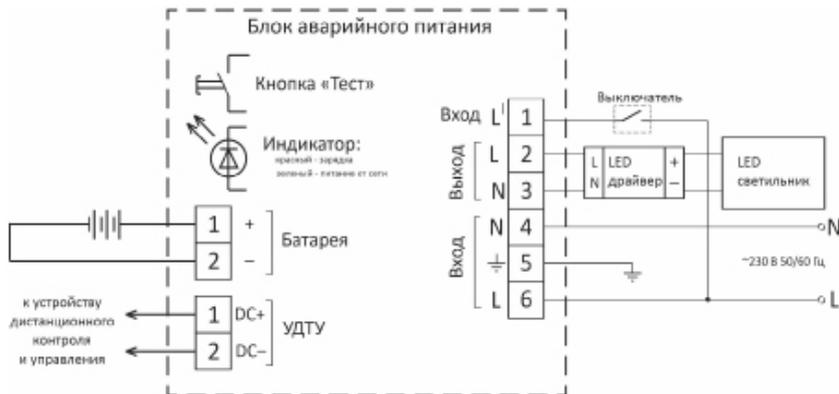
Рисунок 2 – Схема подключения БАУ для работы в основном режиме
