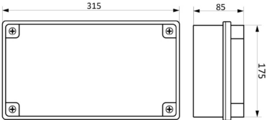
Рисунок 1 – Габаритные размеры БАУ
