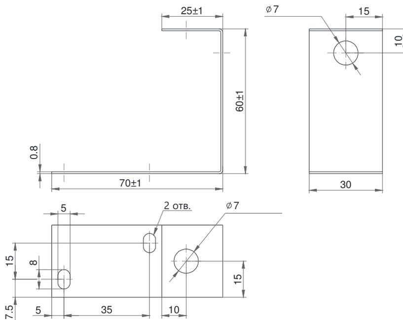
Рисунок 2 – Габаритные и установочные размеры скобы
